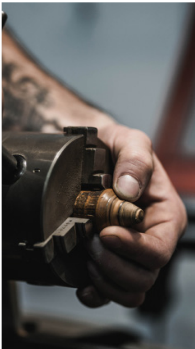
Préparation au tournage d'une embouchure.
