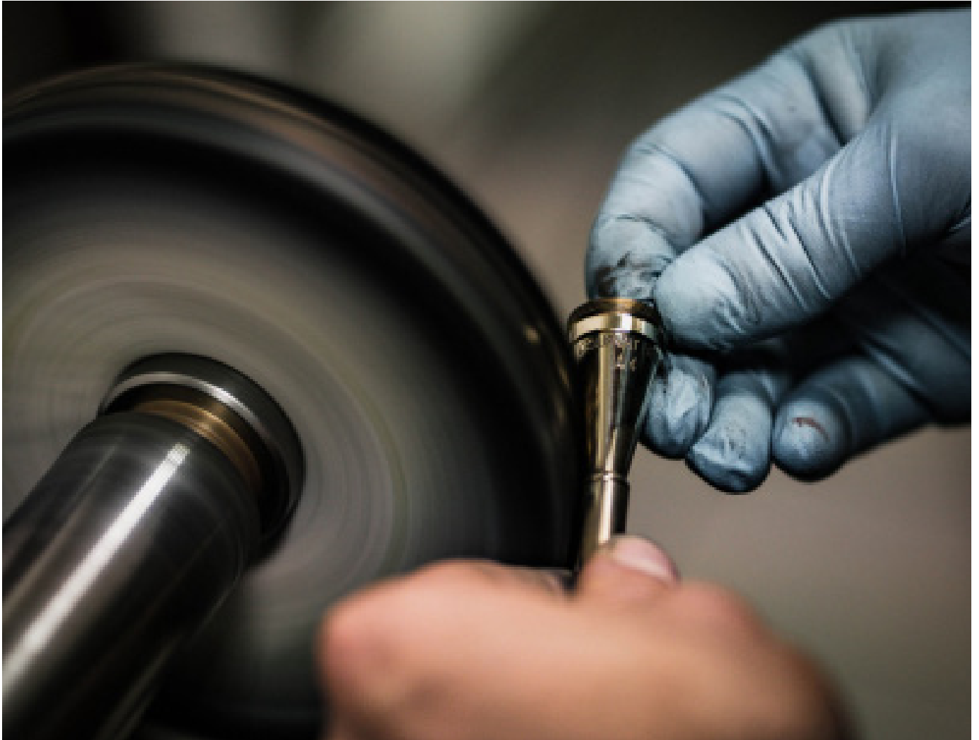
Polissage d'une cuvette 1789.
